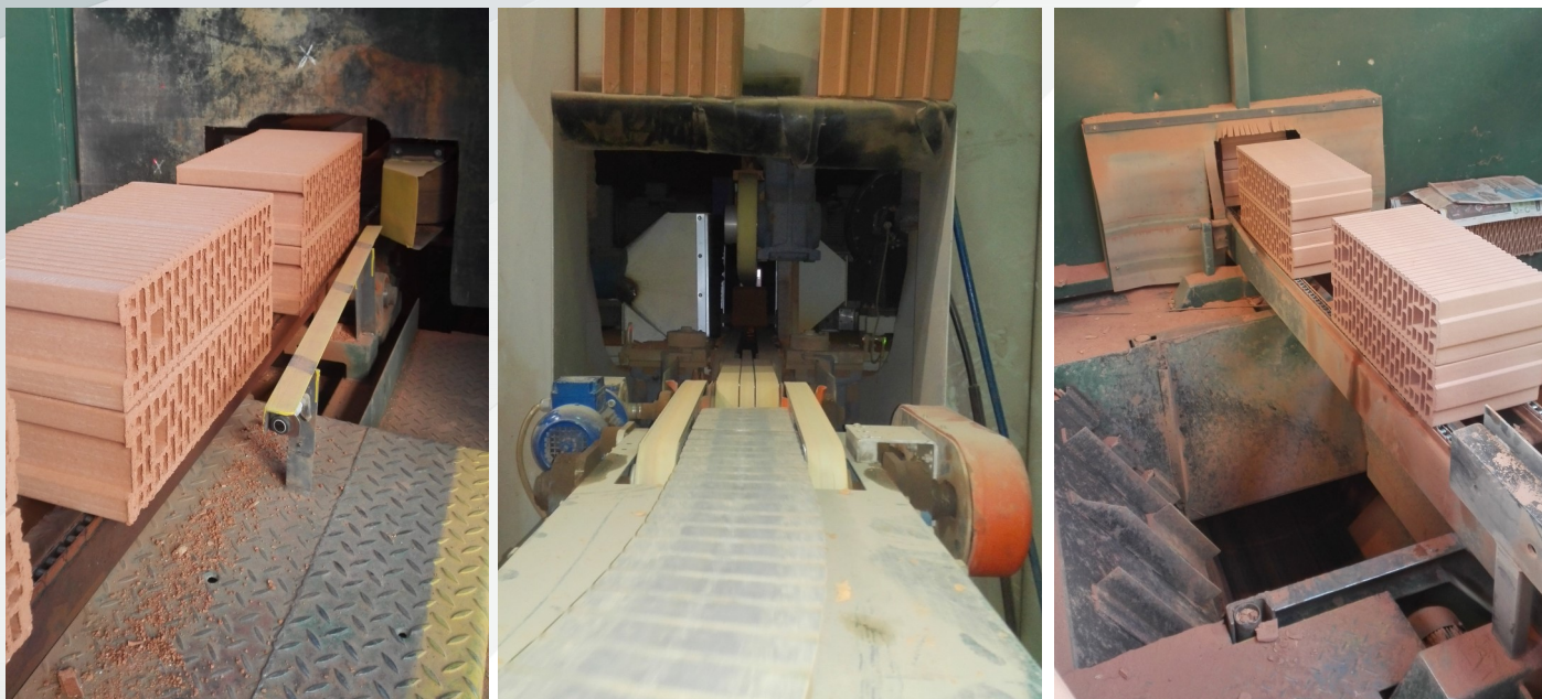
Vstup, pracovní prostor a výstup výrobní linky pro broušení cihel
